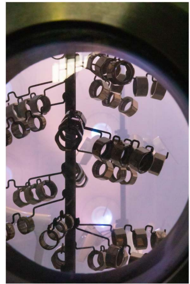
آبکاری تحت خلاء PVD (Physical Vapor Deposition)
